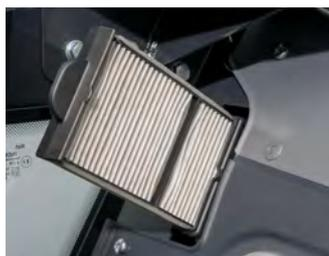
I filtri dell'aria sono facilmente accessibili per facilitare la manutenzione.
