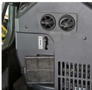
I filtri dell'aria sono facilmente accessibili per facilitare la manutenzione.
