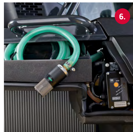
3. Filtro dell'aria 6. Pompa di rifornimento
