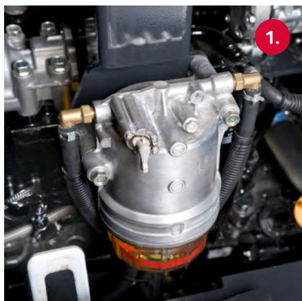
1. Filtro carburante con separatore dell'acqua 4. Batteria
