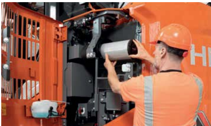
Sul ZX135US-7 è stato migliorato l'accesso ai filtri.
