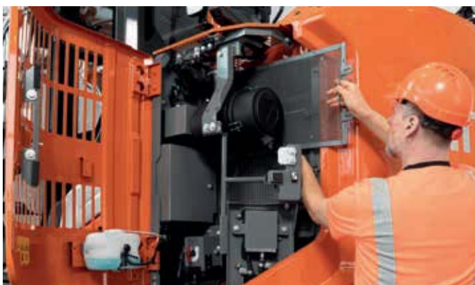
Lo sportello maggiorato del radiatore (ZX135US-7) fornisce un facile accesso per la pulizia e la manutenzione.
