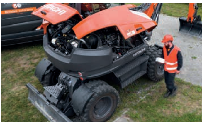
Il facile accesso ai componenti semplifica la manutenzione.
