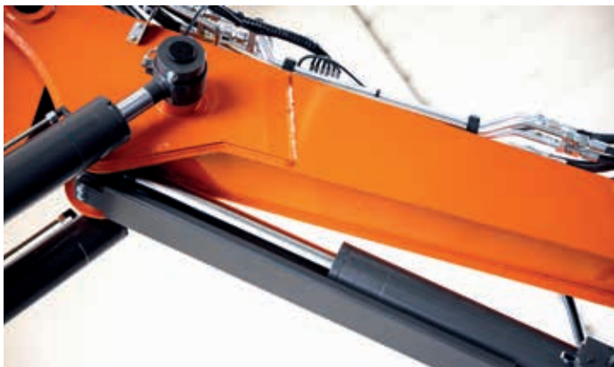
La protezione del cilindro del braccio aumenta la durevolezza.
