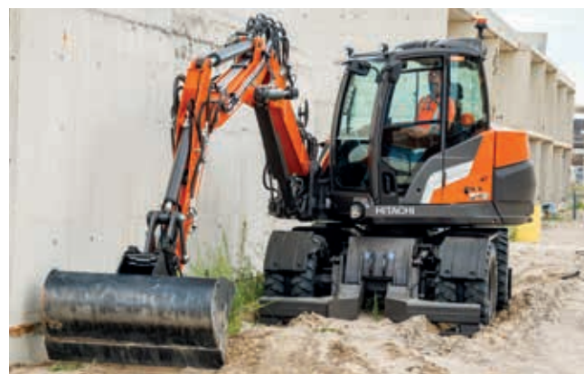
Lavora efficacemente nei piccoli spazi, grazie al raggio di rotazione ridotto e al braccio girevole.
