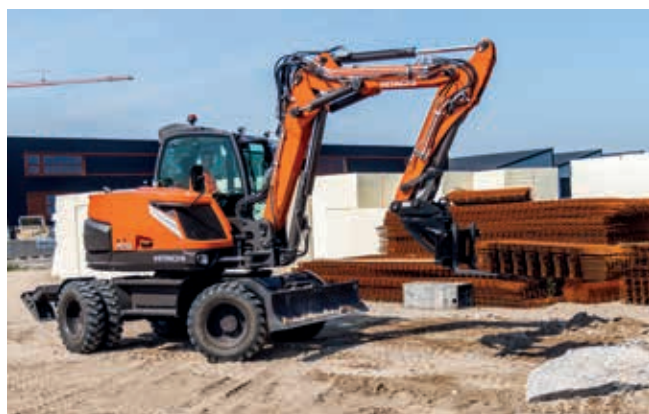
Manovrabilità eccezionale con le quattro ruote sterzanti.
