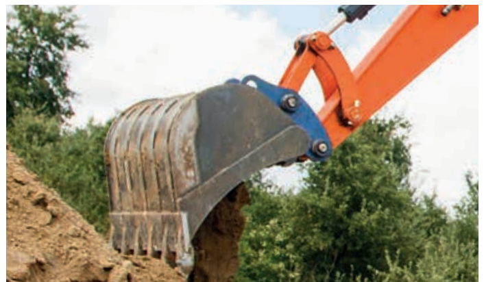
Gli attrezzi da scavo di alta qualità comprendono denti autoaffilanti e adattatori affidabili, per garantire la precisione del montaggio.
